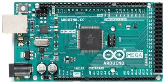
Figura 4-5: Placa Arduino con ATmega2560
