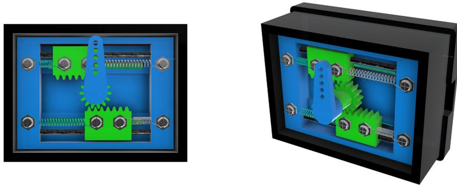
Figura 3-18: Esquema sistema piñón cremallera
