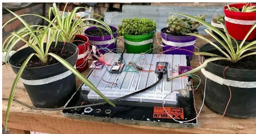
Fig. IV.11: Montaje de la prueba: dos CCM-P con plantas cintas
