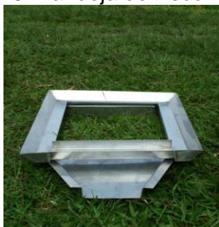
Figura 10. Bandeja de Escorrentía.
