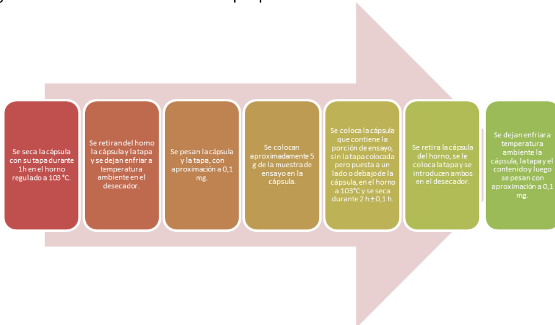
Figura 2. Determinación de humedad por pérdida en masa a 103 °C
