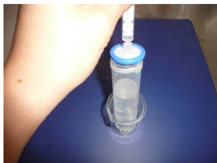
Figura 7. Filtración de Hidrolato por SWINNEX
