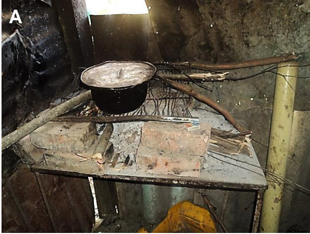
Anexo 14. Tipo de hornilla. A) y B) Hornilla con cámara de combustión abierta. C) y D) Hornilla con cámara de combustión semicerrada. E) - G) Hornilla con cámara de combustión con chimenea. (Fuente propia)
