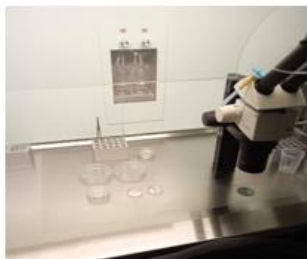
Figura 7. Gaseado y pre calentamiento de cajas Petri con medio de cultivo para mantener su temperatura y pH.
