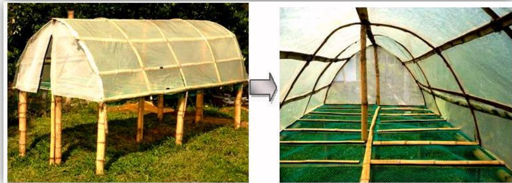
Figura 10. Secador solar parabólico tipo túnel construido en estación piscícola
