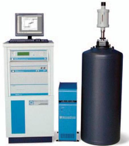
Figura 4.3. Algunos componentes del “PPMS”. De izquierda a derecha, consola de control, torre electrónica del “Control Area Network (CAN)” y el “Dewar” con ensamblaje de sonda criogénica.
