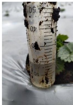
Figura 12. Medición de descarga de un gotero en un minuto.
