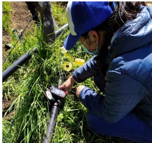
Figura 6. Medición de cota de manómetro ubicado al inicio del bloque de riego.
