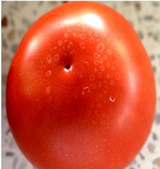
Figura 31. Recubrimiento con almidón modificado con ácido cítrico
