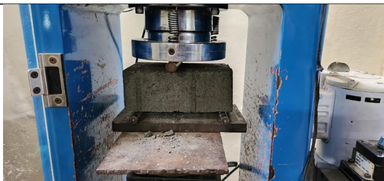
Ilustración 13. Ensayo de resistencia a la flexión
