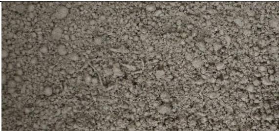
Ilustración 7. Algunos gránulos de APEBD se transforman en fibras durante el mezclado
