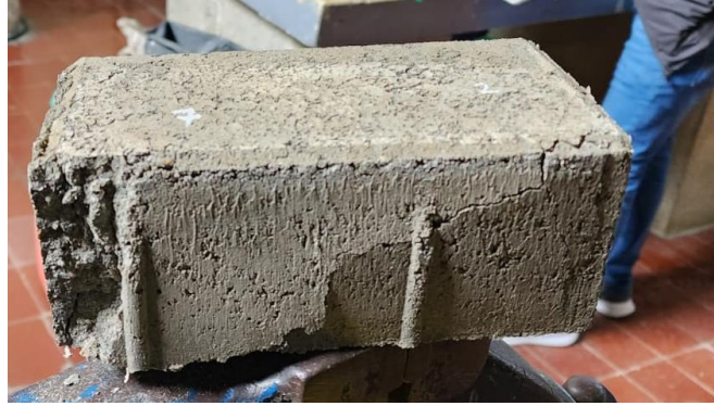
Ilustración 21. Falla de un adoquín sometido al ensayo de compresión
