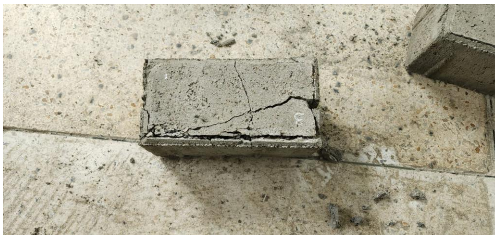
Ilustración 25. Falla a la compresión de un adoquín con aglutinado 1%
