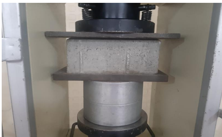
Ilustración 20. Adoquín de concreto sometido al ensayo de resistencia a la compresión
