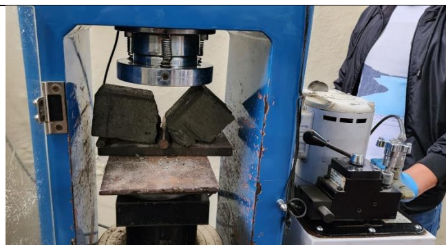
Ilustración 14. Falla llevada a la rotura bajo el ensayo de resistencia a la flexión
