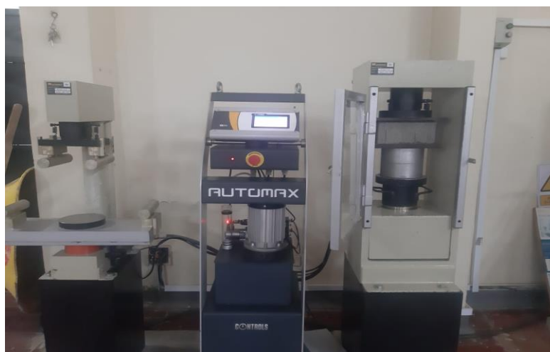
Ilustración 19. Ensayo de resistencia a la compresión a los 28d
