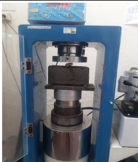
Ilustración 11. Ensayo de resistencia a flexión
