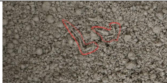
Ilustración 8. Se resalta APEBD en forma de fibras por efecto del mezclado
