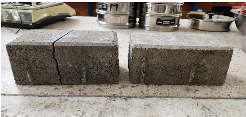
Ilustración 22. Falla típica de un adoquín sometido a ensayo de flexión.
