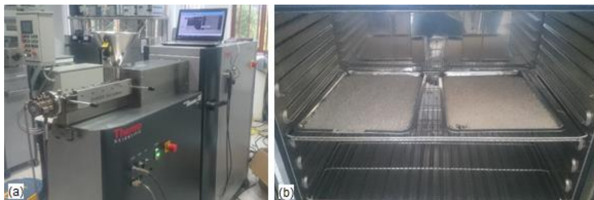
Figura 8. Obtención del almidón termoplástico con ZnO-NPs. (a). Extrusión de la mezcla y obtención del TPS y (b). Secado de los pellets.
