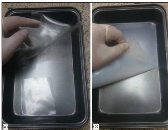
Figura 28. Películas de almidón elaboradas por casting (a). Sin ZnO-NPs y (b). Con ZnO-NPs (2,5%).
