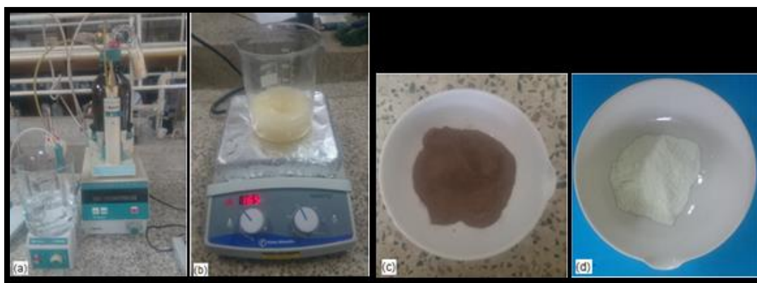
Figura 1. Síntesis de las ZnO-NPs morfología esférica: (a). Adición del agente precipitante al sistema etilenglicol – acetato de cinc y agua, (b). Eliminación de la fase líquida, (c). Precalcinado después de macerado, y (d). Polvos de ZnO obtenido después del tratamiento térmico a 600^\circ C
