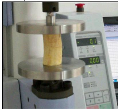
A partir de la gráfica fuerza – distancia (deformación) obtenida mediante el software Trapezium 2, v. 2.3, se obtuvo la fuerza máxima requerida para deformar la muestra del plátano (Figura 6).
