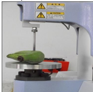
A partir de la gráfica fuerza – distancia, obtenida mediante el software Trapezium 2, v. 2.3, se obtuvo la fuerza máxima requerida para penetrar la cáscara del plátano (Figura 4).
