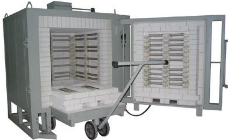
Figura 6. Horno de hasta aproximadamente 4.000 litros.
