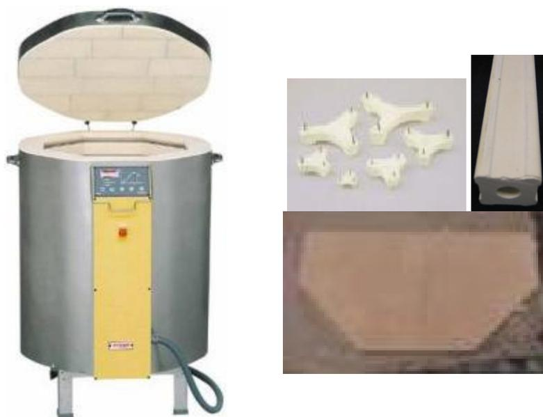
Figura 19. Horno eléctrico y algunas herramientas refractarias que lo complementan.
