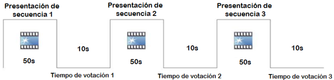
Figura 5.26. Diagrama de presentación de secuencias ITU-T P.910
