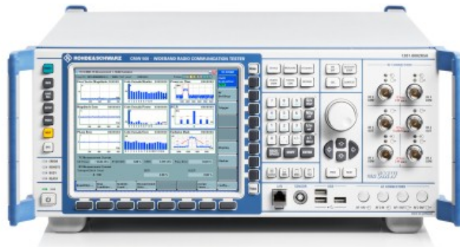
Figura 3.5. Analizador de comunicaciones de banda ancha de Rohde & Schwarz modelo CMW500
