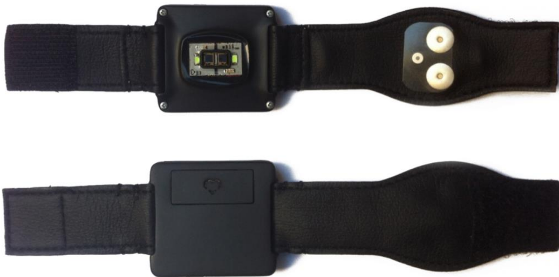
Figura 4. Pulsera E3 wristband. Fuente: Garbarino et al. [45]
