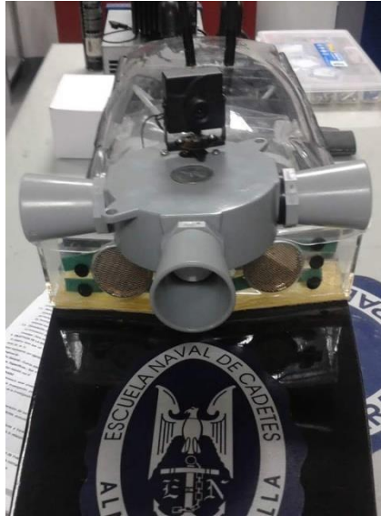
Figura 8. Arreglo de sensores ultrasónicos. Fuente propia del autor.
