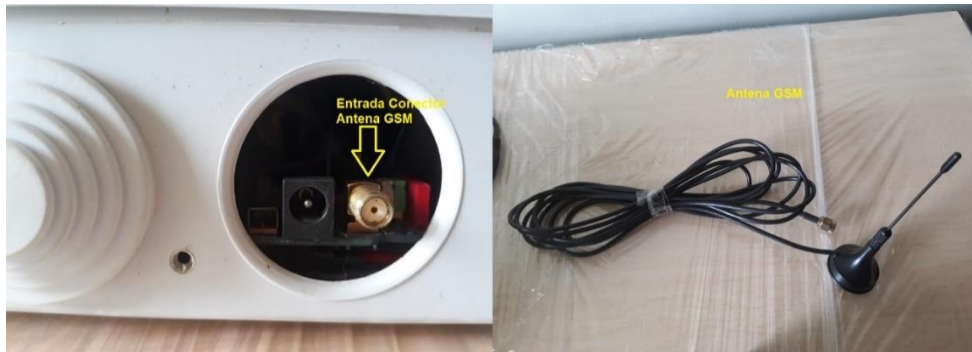
Figura A.3 Antena GSM Fuente: Elaboración Propia
