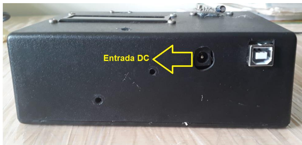
Figura A.7 Conexión a fuente de poder DC 5V 1A Fuente: Elaboración Propia
