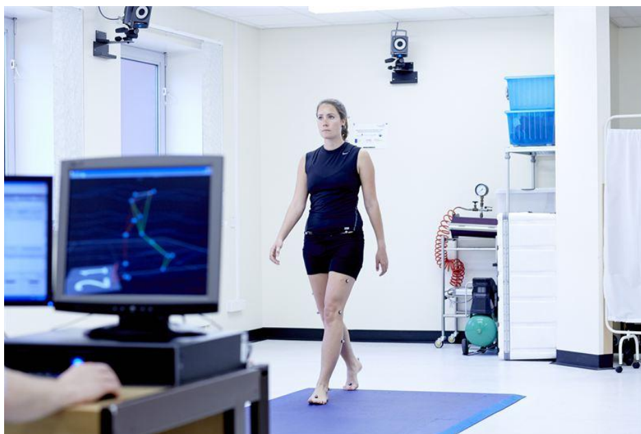
Ilustración 18. Ejemplo de un entorno de Captura de marcha con sistema Vicon, tomado de [17].
