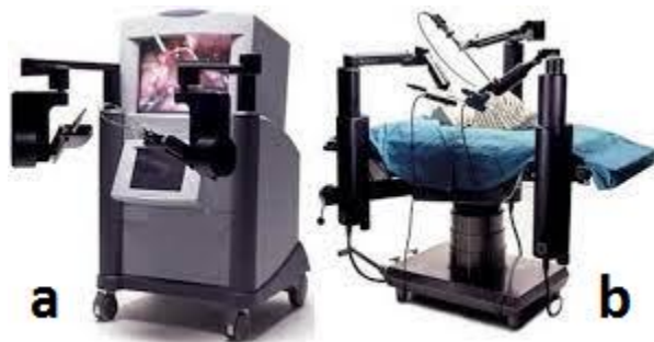
Figura 2.5 Robot Zeus. a) Consola b) Estructura brazos. Fuente. Tomado de [37].
