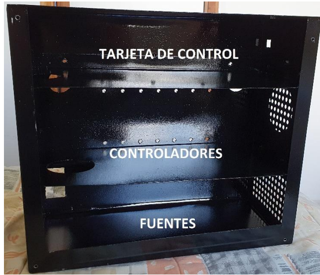
Figura 3.15. Caja de circuitería del sistema.
