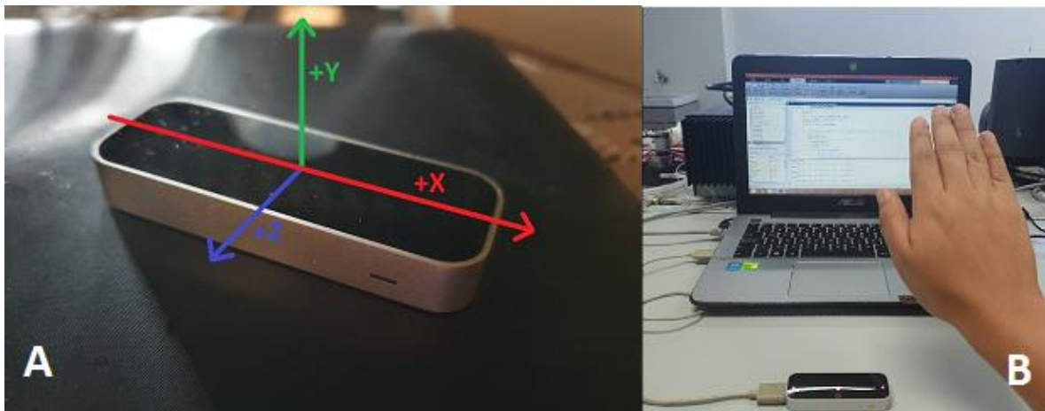
Figura 3.22. Dispositivo de Captura de gestos Leap Motion. A. Ejes cartesianos de operación. B. Captura de movimiento. Fuente. Tomada de [66].
