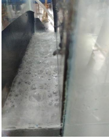
Figura 4.7. Formación de una capa de espuma de sólidos de remoción en la zona de visualización del tanque DAF prototipo de laboratorio.
