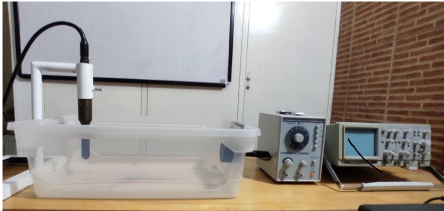
Figura 44. Vista Frontal del montaje realizado para realizar calibración del transductor Furuno.
