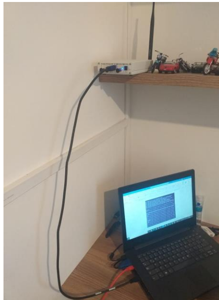
Ilustración 1. Conexión USRP a servidor físico
