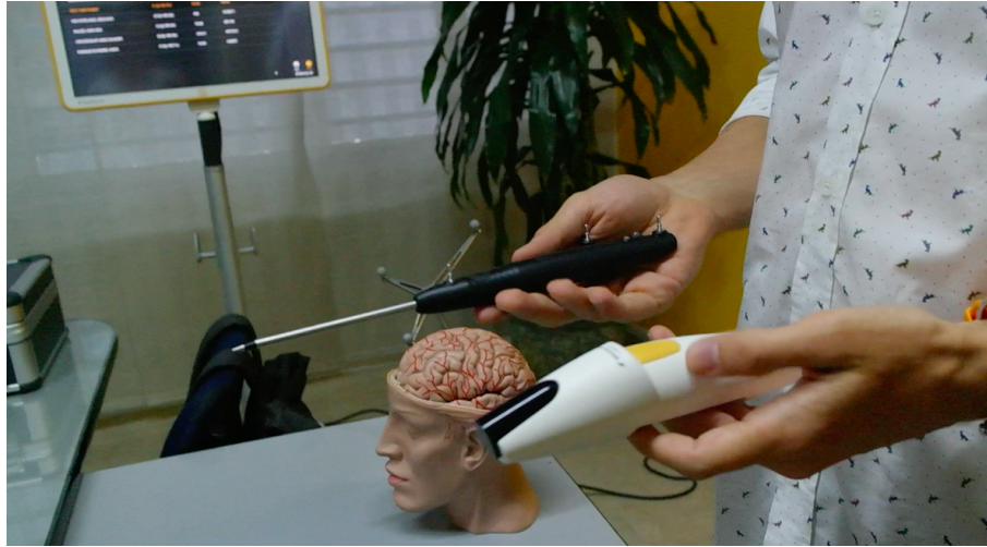
Figura 4.5: Instrumentos de registro puntero y láser
