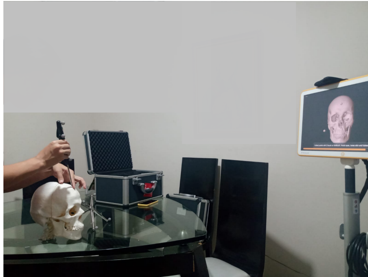
Figura 4.21: Registro de puntos en el phantom
