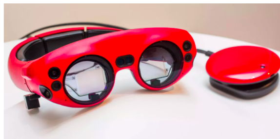
Figura 2.7: Un ejemplo comercial de Optical See-Through, OST
