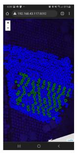
Figura 3.26: Interfaz de servicio web para muestreo manual, en verde las plantas con información completa, en azul las plantas por completar. Fuente: propia
