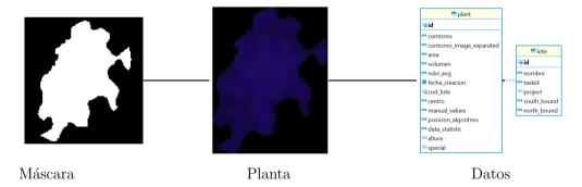
Figura 3.23: Flujo de extracción de variables: La máscara corresponde a la detección del árbol. La máscara se aplica a la imagen RGB de tres bandas para extraer los datos y almacenarlos en una base de datos relacional Mysql que fue necesaria para la persistencia de datos [62]. Fuente: propia
