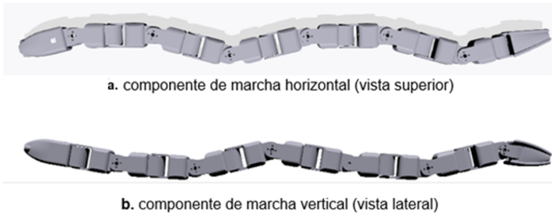
Figura 3.13: Modelo de robot serpiente de 12 eslabones ajustado a la locomoción sidewinding .
