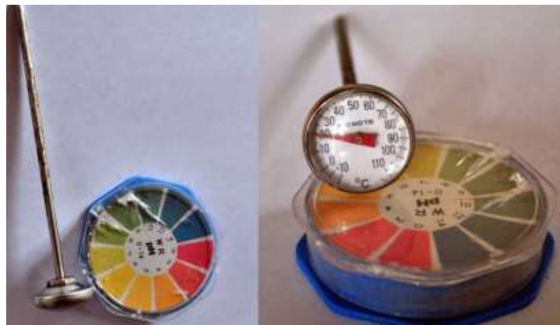
Figura 10. Termómetro Mengte y cinta medidora de pH utilizadas para control de variables
