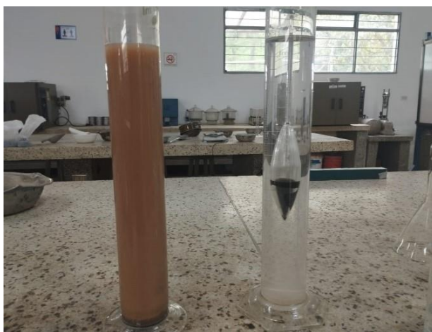
Ilustración 15. Ensayo de granulometría por hidrómetro.
