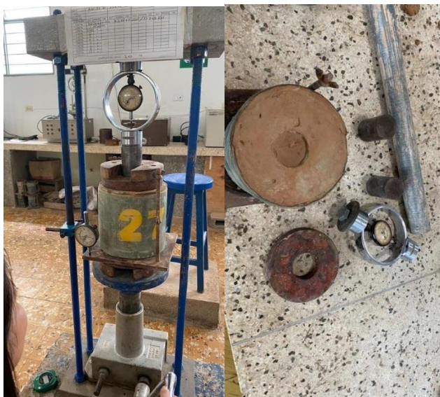
Ilustración 13. Ensayo de potencial de expansividad en el aparato de Lambe.
