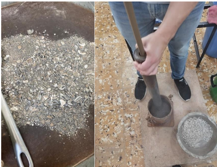
Ilustración 11. Compactación de la ceniza de concha de molusco para obtener material Pasa Tamiz N°200.
