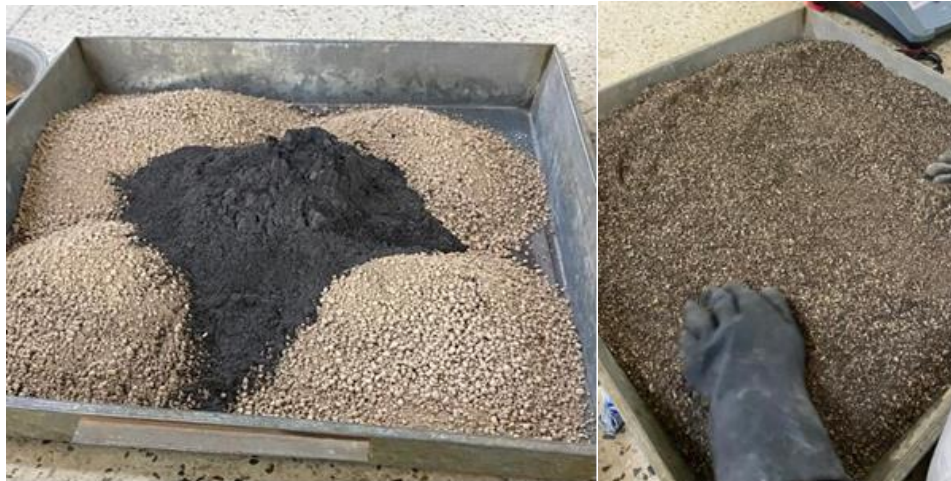
Ilustración 12. Mezcla de muestra de suelo con ceniza de cáscara de coco.
