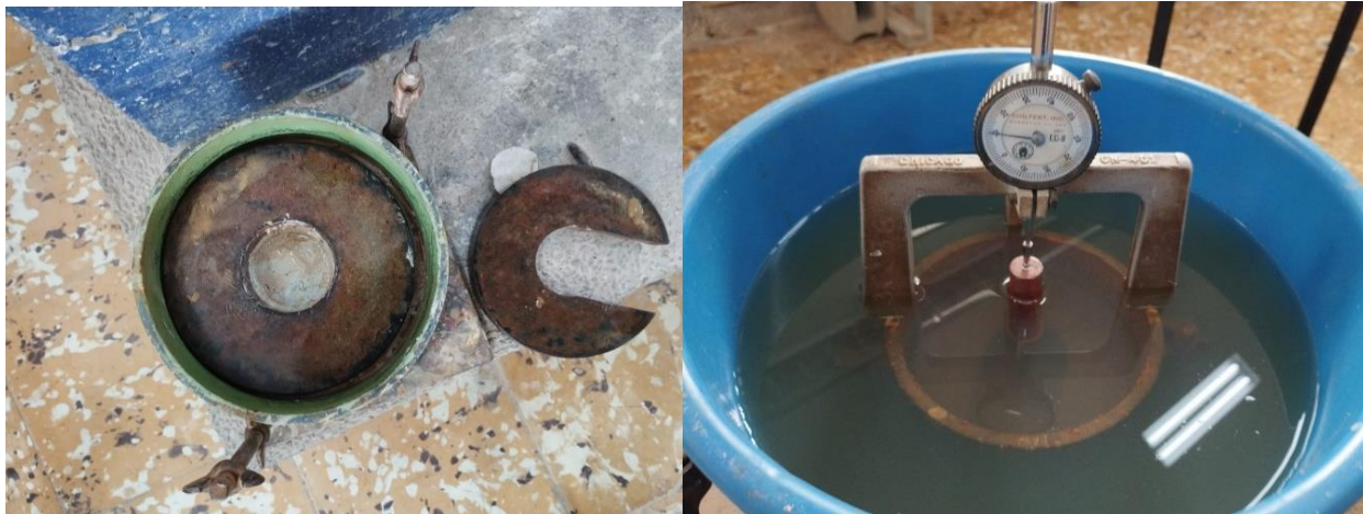
Ilustración 19. Ensayo CBR en muestra inalterada.
