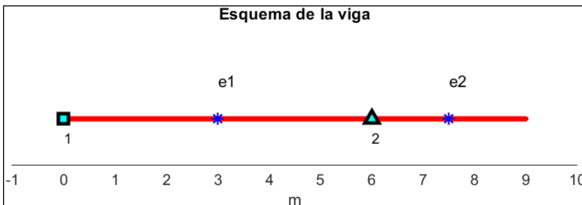
Figura 121: Esquema de una viga empotrada en un extremo, apoyo móvil y voladizo en AIRO correas.
