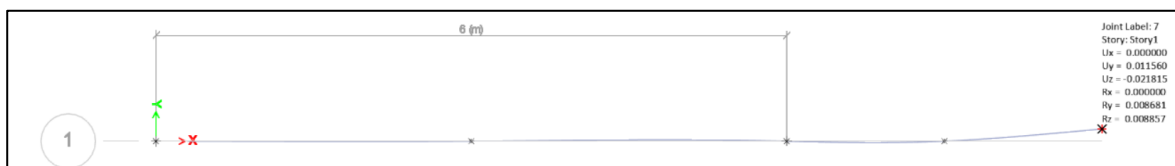
Figura 132: Diagrama de desplazamientos para flexión alrededor del eje débil de la viga empotrada en un extremo, apoyo móvil y voladizo en Etabs.
