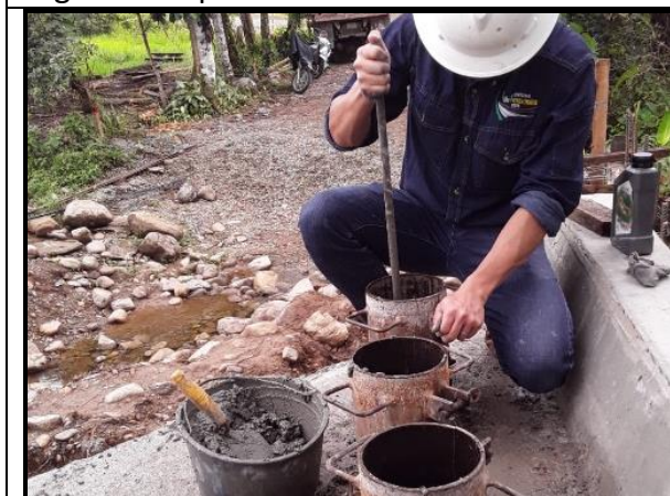
Fotografía 41. Elaboración de muestras para ensayo de compresión del concreto.
