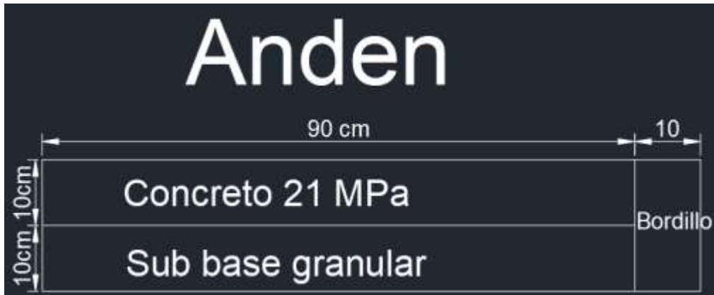
Imagen 20. Espesores de la estructura del andén.
