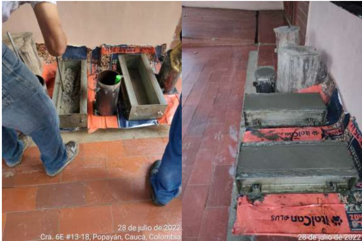
Imagen 29. Vigas de concreto para ensayos
