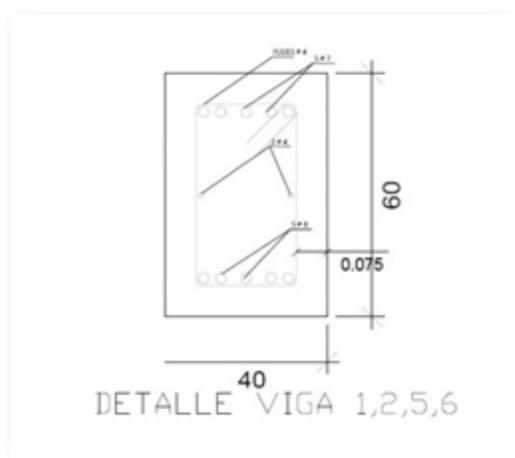
Figura 29: Detalle viga cimentación 1, 2, 5, 6
