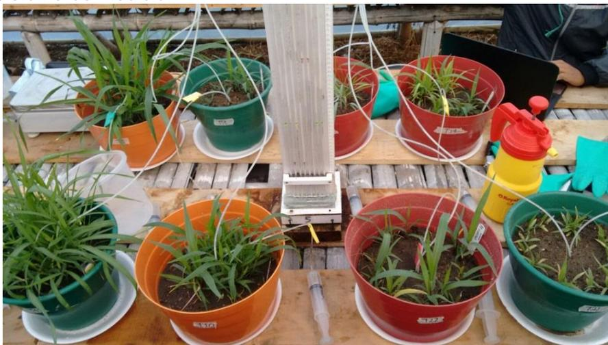
Este sistema permitió realizar las lecturas a -15 kPa (12 cm), -30 kPa (24 cm) y -50 kPa (40 cm), la manguera va conectada a una cápsula porosa de porcelana que se encuentra ubicada en el segundo tercio de la matera donde se realizó la siembra y de está se colocó 15 cm de manguera transparente conectada a una jeringa de 50 ml que sirvió para escorbar o purgar del sistema.
