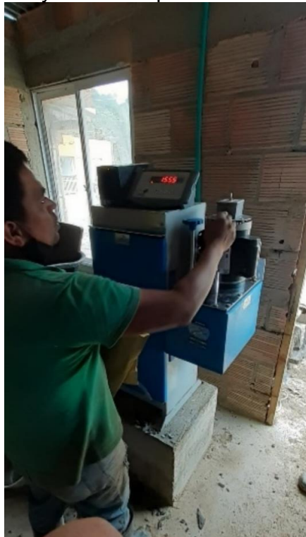
Imagen 67 Ensayo a la compresión de los especímenes
