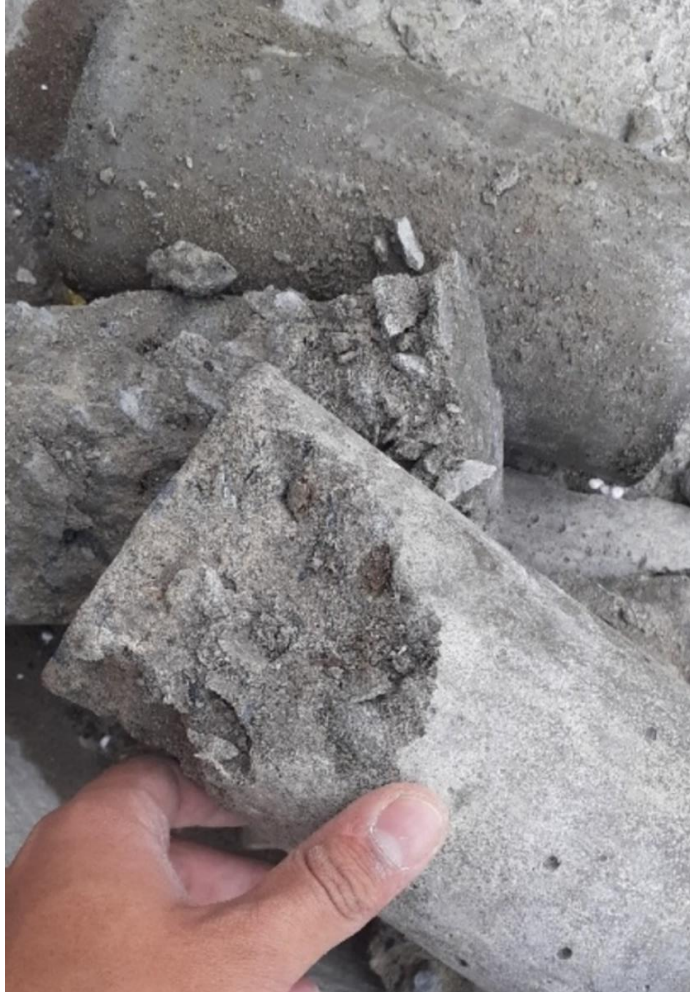
Imagen 68. Cilindro después de realizar el ensayo a la compresión
