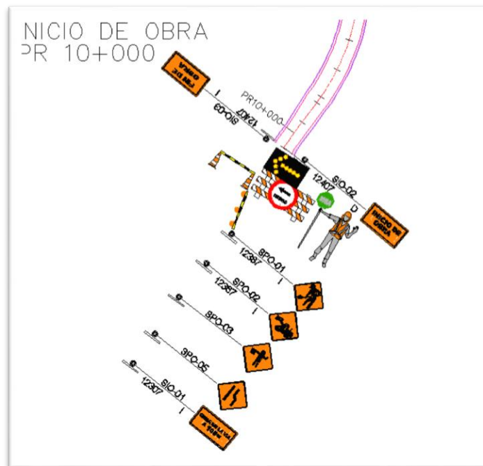
Ilustración 26. Esquematización en el Inicio de obra
