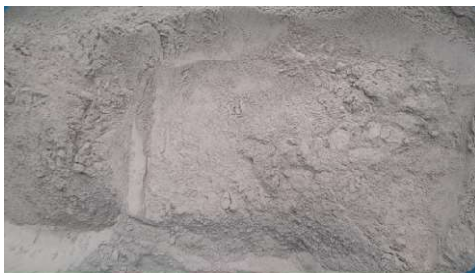
Ilustración 5. Ceniza de cáscara de café pasante del tamiz N°200. Fuente: Elaboración propia.
