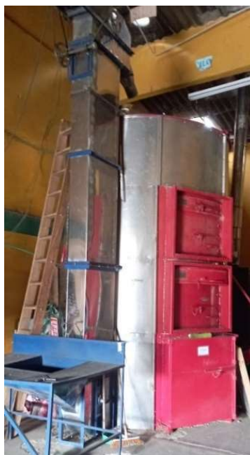
Ilustración 1. Horno de secado mecánico de café o "Silo". Fuente: Elaboración propia.
