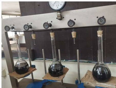
Ilustración 17. Ensayo de gravedad específica. Fuente: Elaboración propia.
