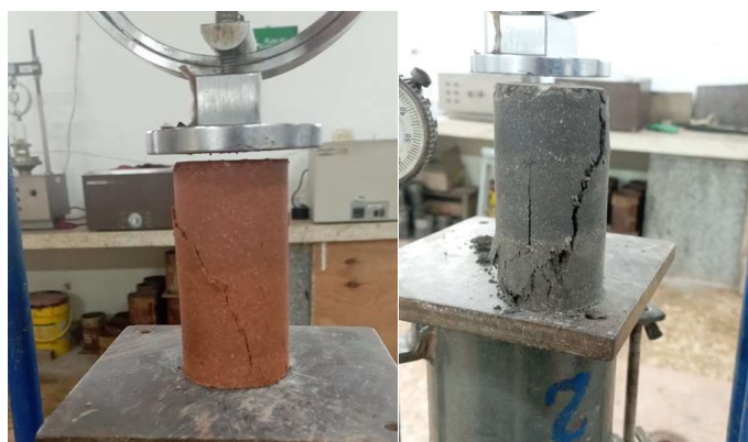
Ilustración 19. Ensayo de compresión simple. Fuente: Elaboración propia.
