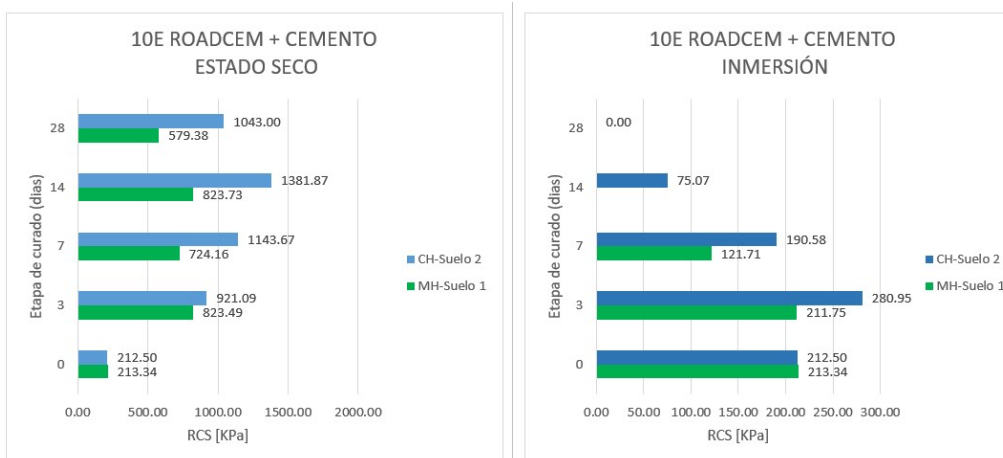
Figura 15. Efecto del estabilizante ROADCEM + cemento en la resistencia a la compresión inconfiada Fuente: Universidad del Cauca, 2020.
