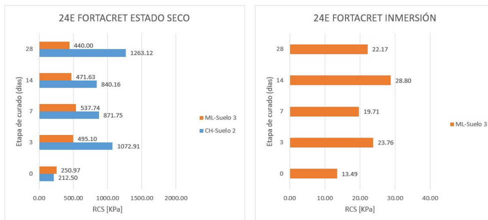
Figura 16. Efecto del estabilizante FORTACRET en la resistencia a la compresión inconfiada. Fuente: Universidad del Cauca, 2020.
