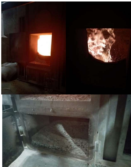
Ilustración 2. Incineración de la cáscara "cisco" de café. Fuente: Elaboración propia.
