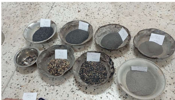
Ilustración 14. Ensayo de granulometría por tamizado para la ceniza de cáscara de café. Fuente: Elaboración propia.
