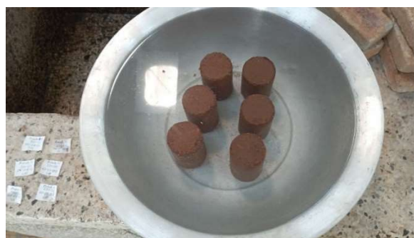
Ilustración 20. Proceso de saturación por inmersión en probetas. Fuente: Elaboración propia.
