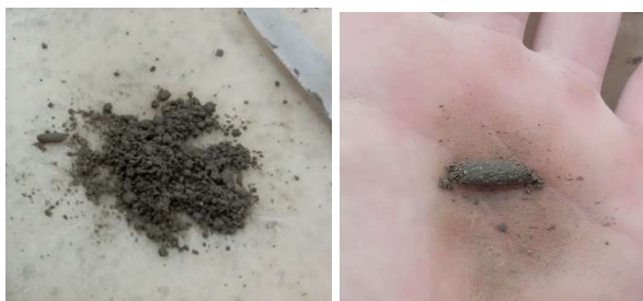
Ilustración 16. Ensayo de determinación del límite plástico e índice de plasticidad de los suelos. Fuente: Elaboración propia.
