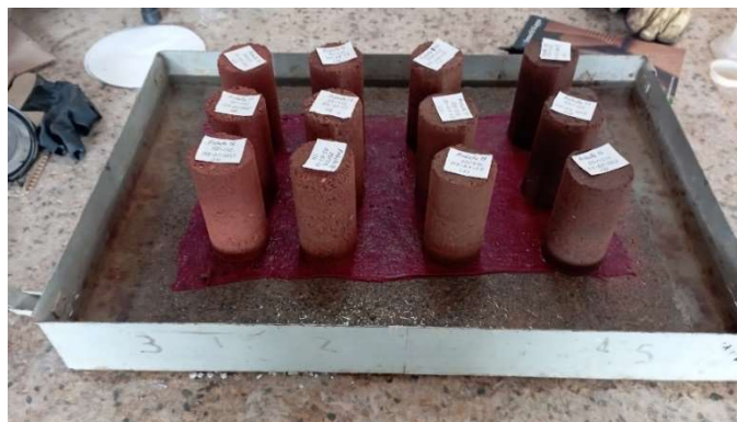
Ilustración 21. Proceso de saturación por ascensión capilar en probetas. Fuente: Elaboración propia.
