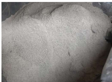
Ilustración 4. Ceniza de cáscara de café molida. Fuente: Elaboración propia.
