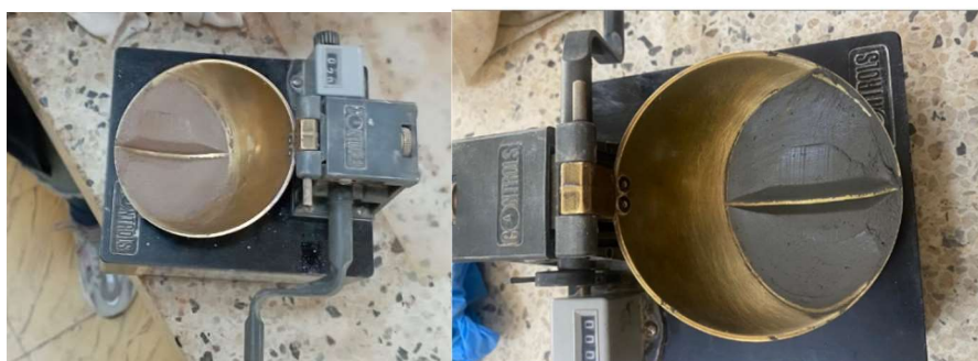
Ilustración 15. Ensayo de determinación del límite líquido de los suelos.
