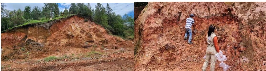
Ilustración 6. Toma de muestras de suelo en la cantera "La Verónica - Río Hondo". Fuente: Registro fotográfico CDT Vial.
