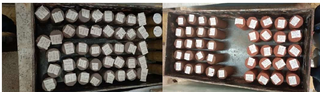
Ilustración 18. Probetas almacenadas para el ensayo de resistencia a la compresión confinada. Fuente: Elaboración propia.
