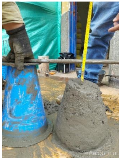
Figura 73. Asentamiento del concreto de cemento hidráulico (slump)
