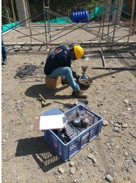
Figura 43. Resultado ensayo densidad en terreno- método cono de arena
