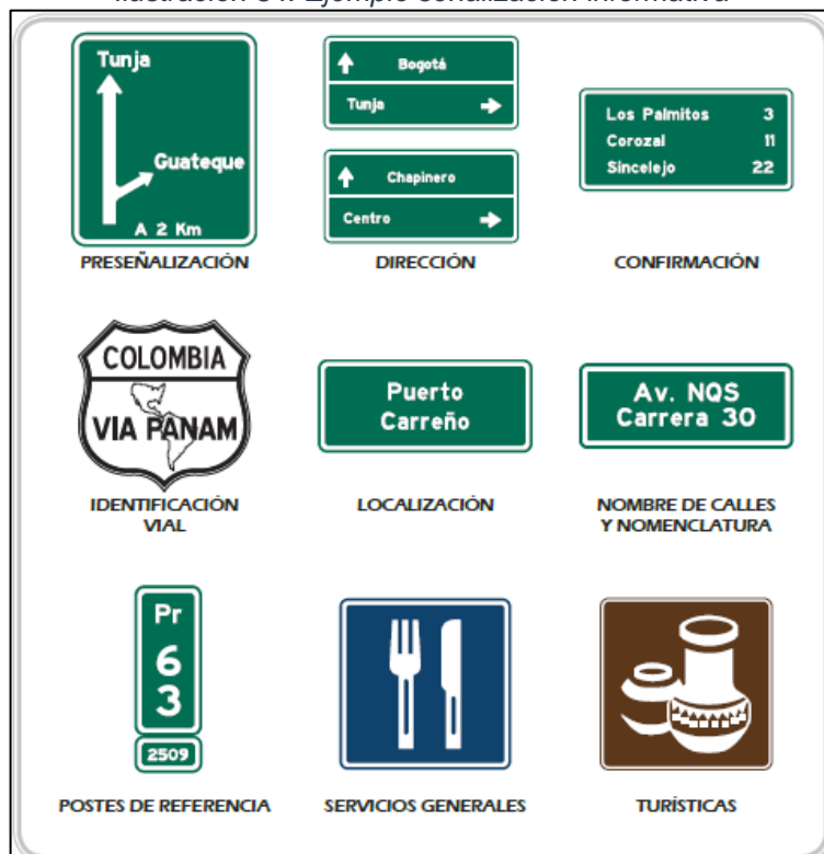
Ilustración 34. Ejemplo señalización informativa
