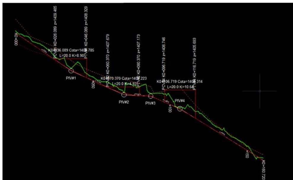
Figura 38. Diseño en perfil de la Calle 1.
