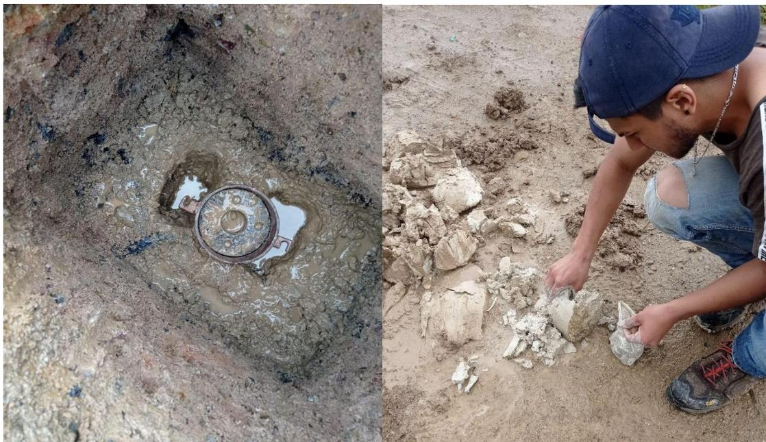
*Imagen 9. Apique con CBR muestra inalterada y Recuperación de Muestras Alteradas.*
