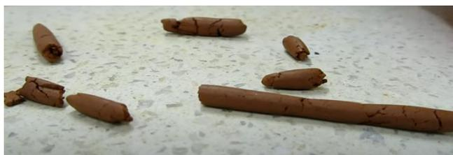
*Imagen 13. Trabajo de laboratorio Ensayo Límite Plástico.*
