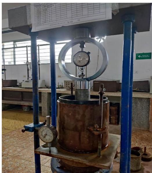
*Imagen 20. Penetración de los moldes.*
