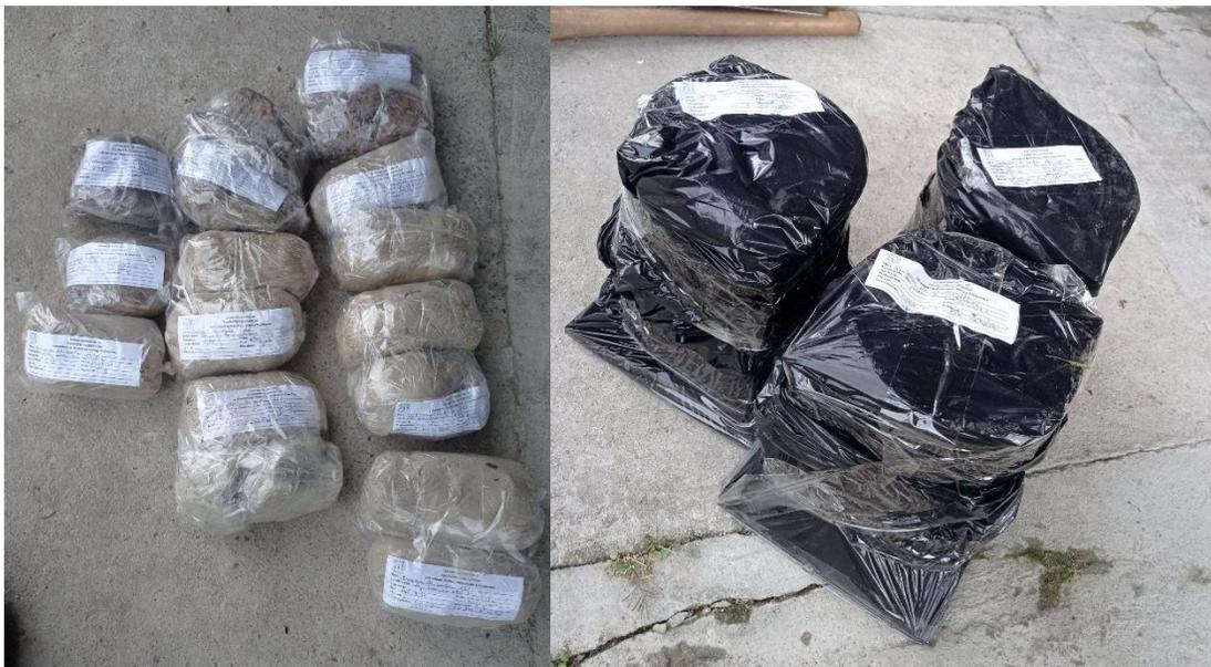
*Imagen 11. Muestras CBR inalteradas y Muestras alteradas recuperadas para transporte.*
