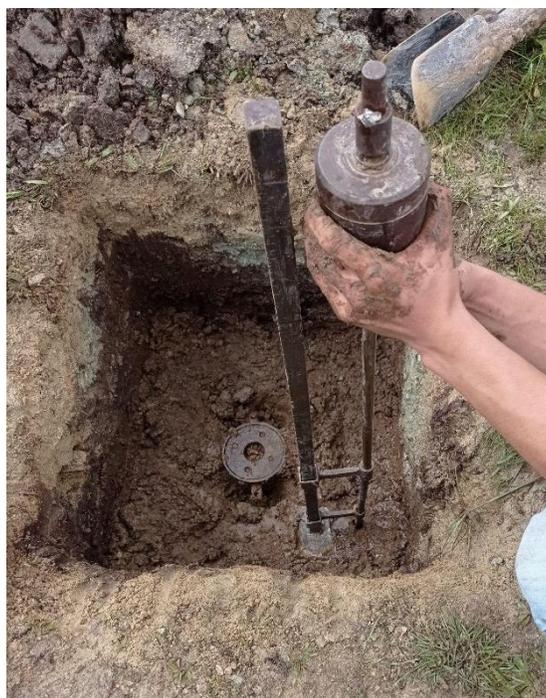
*Imagen 10. Ensayo Penetrómetro Dinámico de Cono (PDC).*
