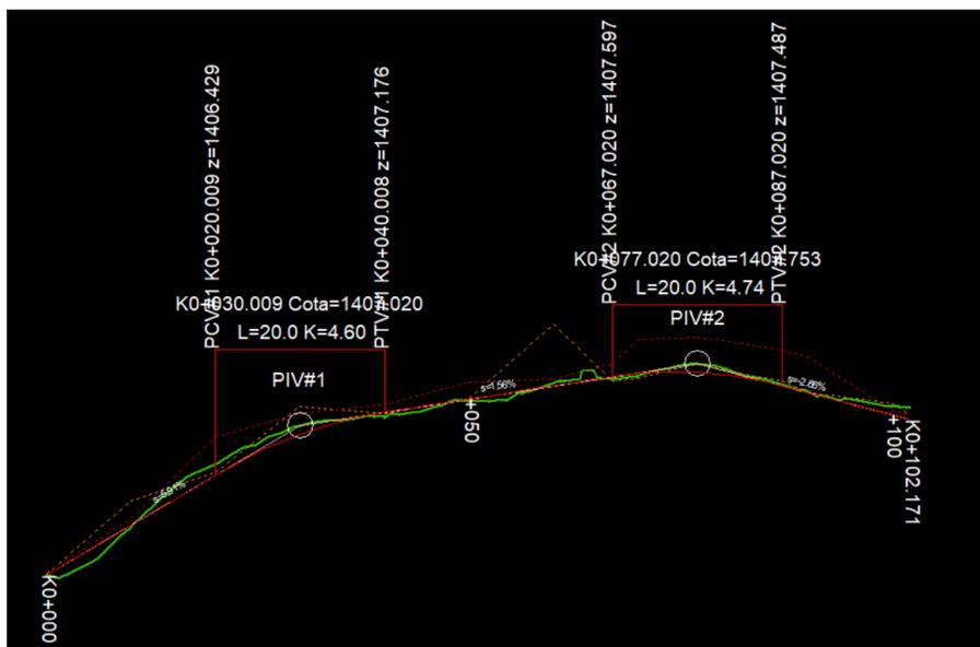
Imagen 23. Diseño en perfil de la Carrera 8. Fuente Topo3.
