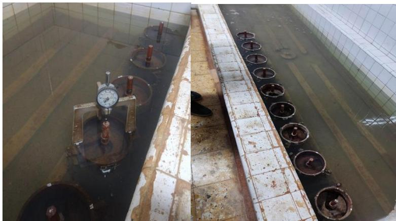
*Imagen 19. Curado de muestras y medición de expansión.*
