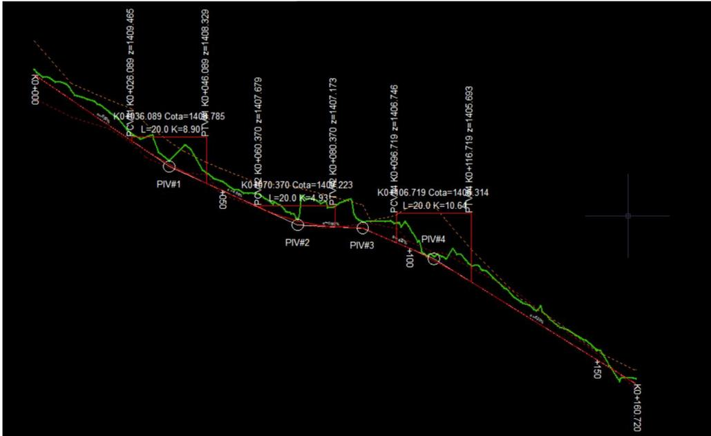
Imagen 25. Diseño en perfil de la Calle 1. Fuente Topo3.
