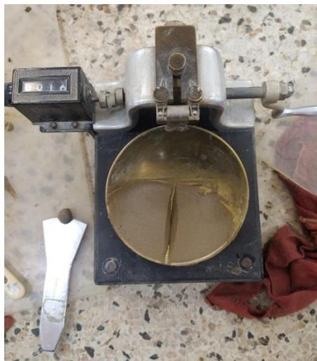
*Imagen 12. Trabajo de laboratorio Ensayo Límite líquido.*
