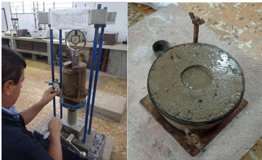
*Imagen 14. Ensayo CBR muestra inalterada.*
