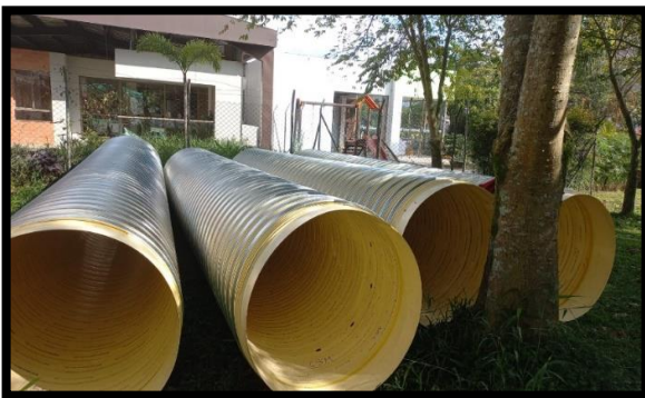
Figura. 35 Tubería tipo Novaloc- Grandes diámetros (51 pulgadas). Cobertura quebrada
