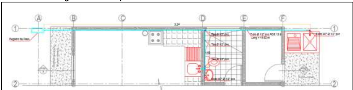
Figura 16 Plano tipo detalle conexiones hidráulicas vivienda nueva.
