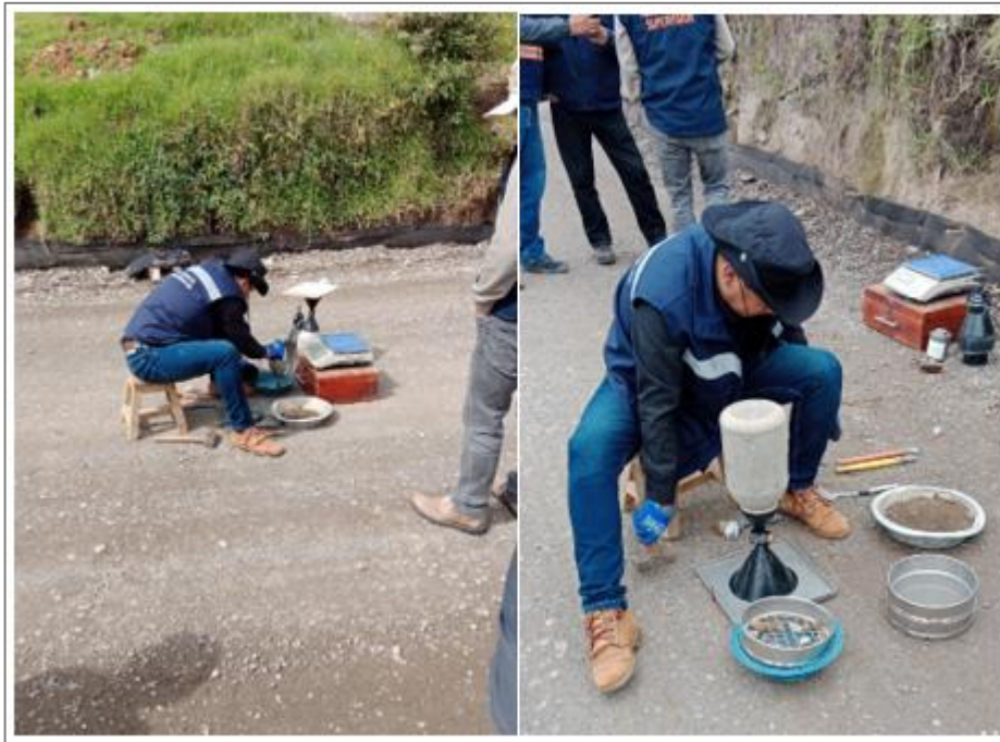
Ilustración 13.68 Ensayo de densidades por personal de interventoría
