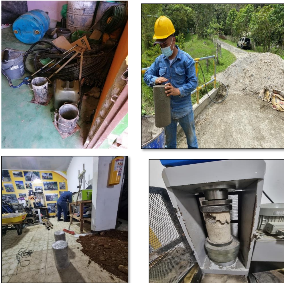
Figura 23: Elaboración de cilindros de concreto en obra para ensayo de resistencia.
