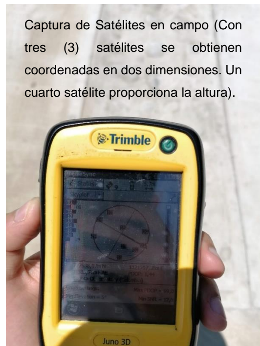
Figura 57: GPS Trimble Juno 3B – Captura de coordenadas en campo.
