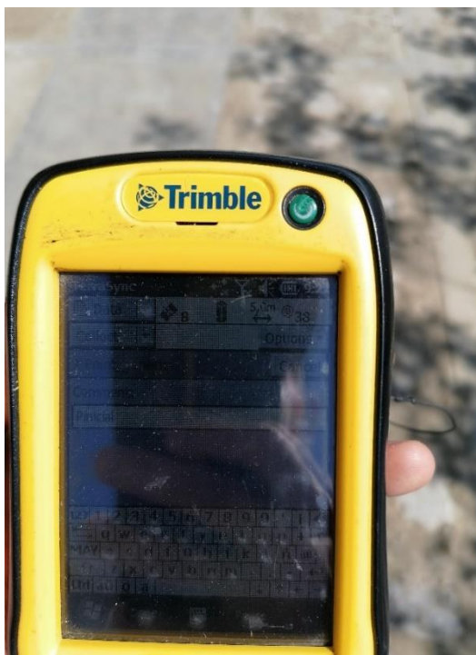
Figura 57: GPS Trimble Juno 3B – Captura de coordenadas en campo.
