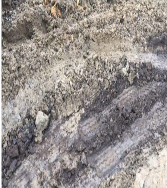
Ilustración 21. Hallazgo de Suelo Arcilloso Color Gris (Tramo 1). Tomada in situ.
