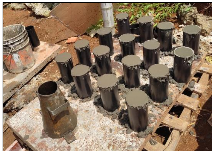
Figura 17. Cilindros de prueba del concreto. Fuente: Propia
