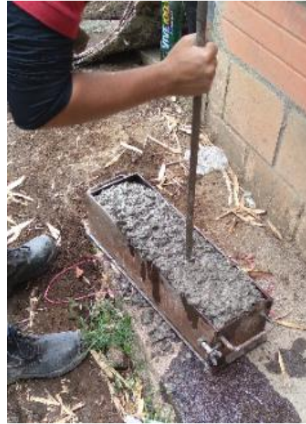
Imagen 137. Toma de muestras en moldes para vigas de concreto. Barrio Patio Bonito.
