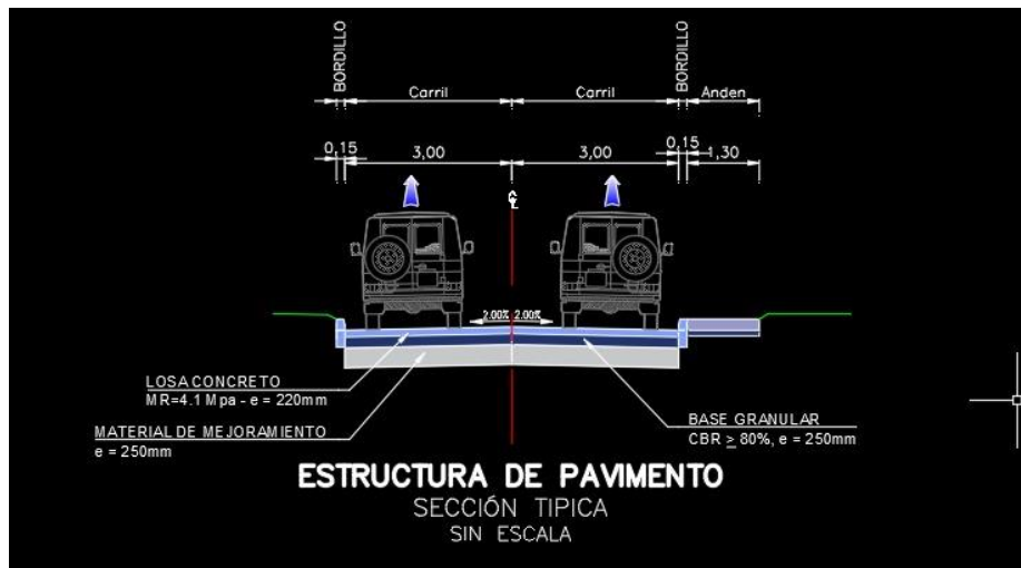
Ilustración 8. Sección Transversal Típica Calle 19. Fuente: AutoCAD.
