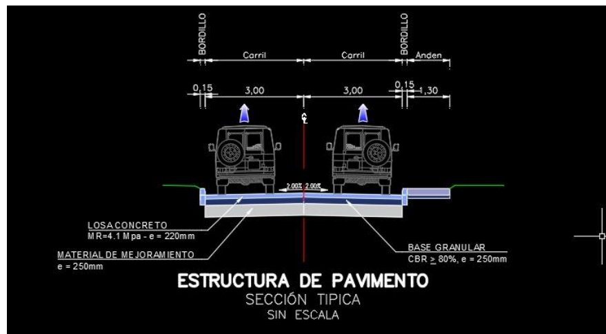
Ilustración 7. Sección Transversal Típica Calle 18. Fuente: AutoCAD.
