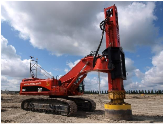
Imagen 98: Piloteadoras de hincado.
