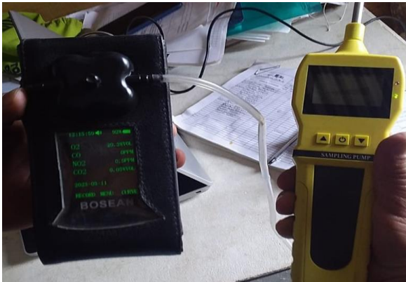
Imagen 36: Medidor de gases en espacios confinados, funciona sólo bajándolo hasta el fondo de la excavación, corriendo el riesgo de dañar el equipo.
