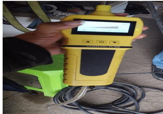
Imagen 37: Medidor de gases conectado a otro equipo y a su vez a una manguera que llega hasta el fondo de la excavación para tomar la medición.
