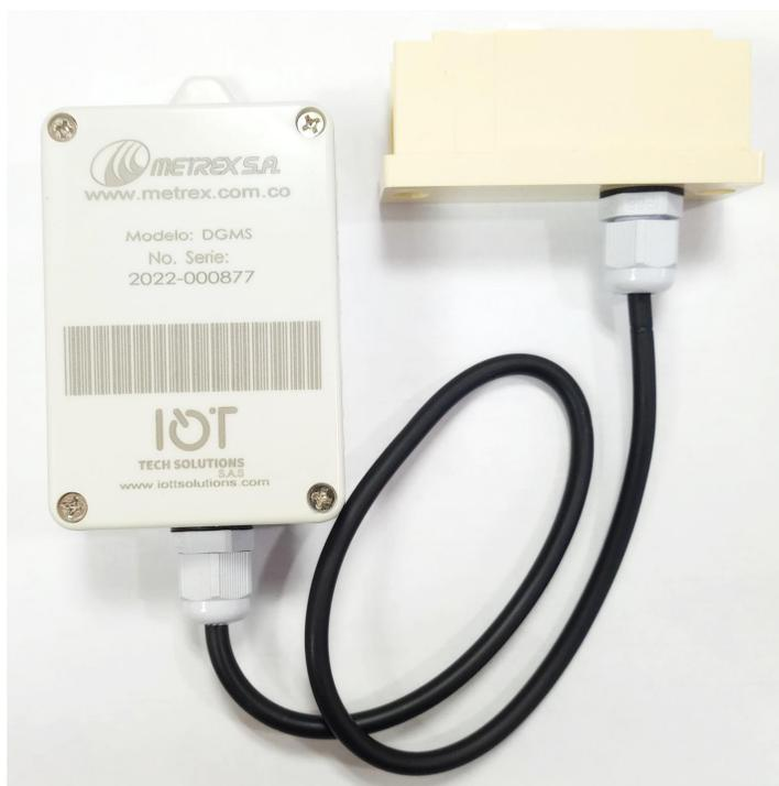
**Figura 8.** Módulo de comunicación DGMS con cable conectado al habitáculo de batería del medidor digital. Fuente propia.
