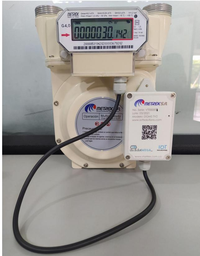
**Figura 14.** Medidor digital de gas modelo G4 durante la ejecución de la prueba de laboratorio sin caja metálica. Fuente propia.
