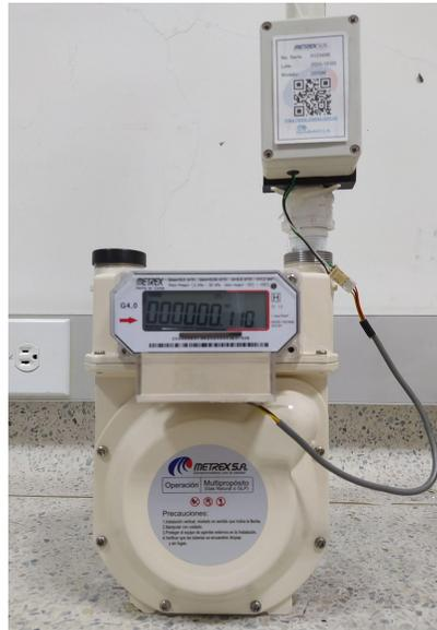
**Figura 20.** Medidor digital de gas modelo G4 durante la ejecución de la prueba de duración real de batería del módulo de comunicación. Fuente propia.
