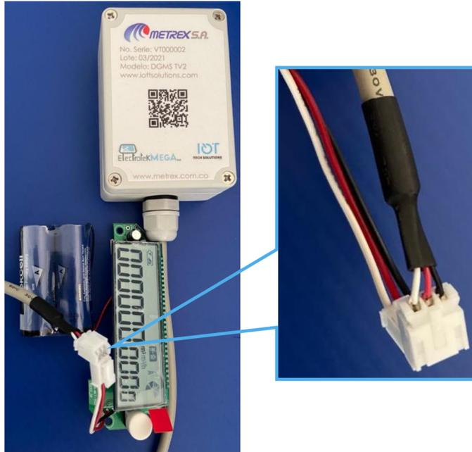
**Figura 10.** Conexión pantalla de medidor de gas G4 tipo digital y módulo de comunicación. Fuente propia.
