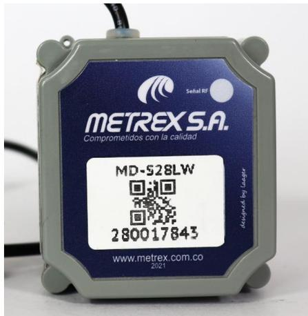
**Figura 34.** Módulo de comunicación basado en tecnología LoRaWAN de Laager. Fuente propia.
